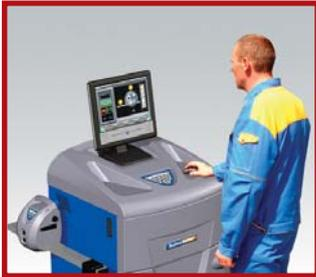
Предназначены для проверки и регулировки углов установки колес автомобилей с диаметром дисков от 12 до 24 дюймов.
