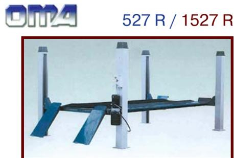
Электрогидравлический четырехстоечный подъемник для регулировки развала - схождения
