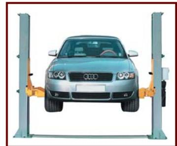
Электрогидравлический двухстоечный подъемник с нижней синхронизацией
