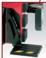
Подъемник с роликами (дополнительно): крепится к корпусу машины, максимальный вес 60 кг, легко устанавливается.
