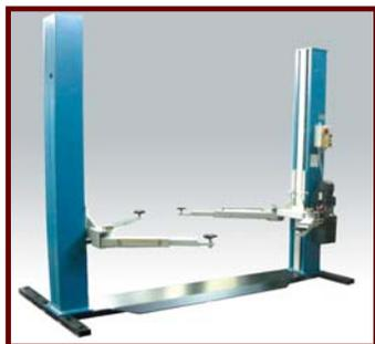
Асимметричный двухстоечный электрогидравлический подъемник с тройными выдвигающимися лапами.
