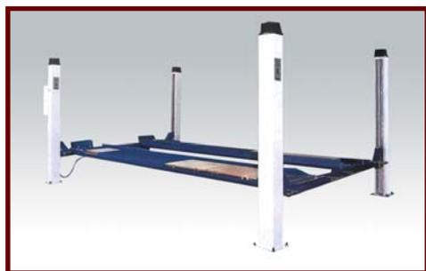
Электрогидравлический подъемник с углублениями и задними подвижными платформами для регулировки развала-схождения
