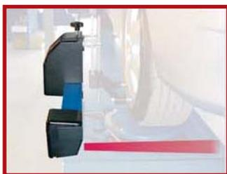
Использование инфракрасных лучей обеспечивает высокую точность и удобство измерений. Каждая CCD камера содержит два излучателя и CCD матрицу высокого разрешения (3648 ячеек).
