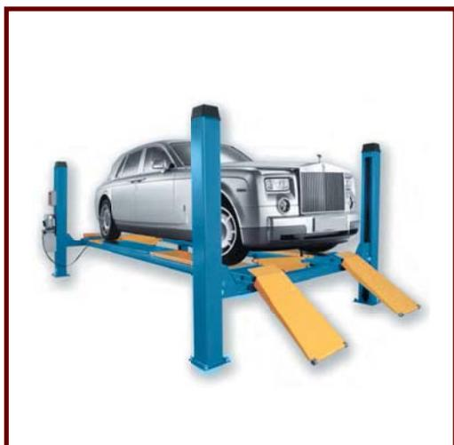
Электрогидравлический четырехстоечный подъемник
